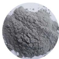
L'alluminio atomizzato grazie all'elevata conducibilità termica trova impiego come riempitivo per resine termoindurenti per realizzare sistemi da colata, strati di collegamento, adesivi.
